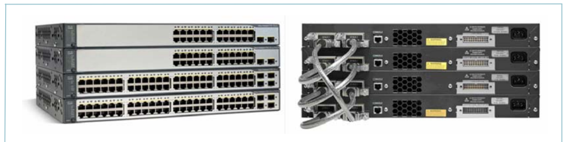
图 1. Cisco Catalyst 3750 v2 交换机（正面与背面）
