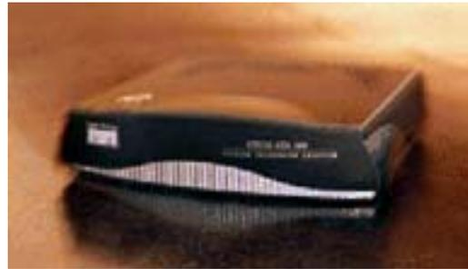
Cisco ATA 186 및 188 아날로그 전화기 어댑터는 일반적인 아날로그 전화기와 팩스를 IP 기반의 전화기 네트워크에 연결합니다. 어댑터에 있는 두 개의 음성 포트 각각은 각각의 전화 번호를 지원하기 때문에 두 개의 구별된 회선을 제공합니다. 또한, 내부 이더넷 스위치는 RJ-45 인터페이스를 사용하여 10/100BASE-T Ethernet 네트워크에 직접 연결할 수 있도록 합니다. Cisco ATA 188 Analog Telephone Adaptor는 같은 장소에 설치된 PC 또는 기타 이더넷 기반의 디바이스와 LAN을 연결할 수 있는 추가 이더넷 포트를 지원합니다.
